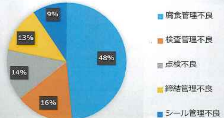
設備の維持管理不良 (H29年～R4年)
