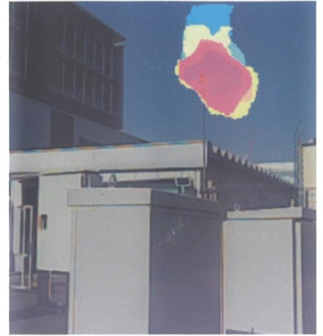
試作機、代替ガスによる屋外試験および可視化画像
